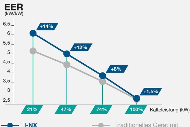
Die Effizienzsteigerung im Vergleich zu ähnlichen Geräten mit fester Drehzahl wird dargestellt durch die Abbildung der EER-Entwicklung unter den in der ErP-Richtlinie 2009/125/EG festgelegten Bedingungen, die für die Berechnung der saisonalen SEER-Parameter erforderlich sind.
