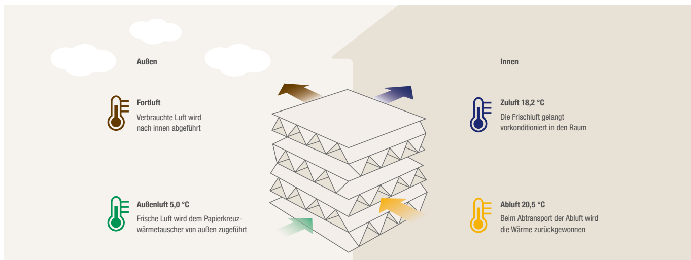
Die Struktur des Papierkreuzwärmetauschers
